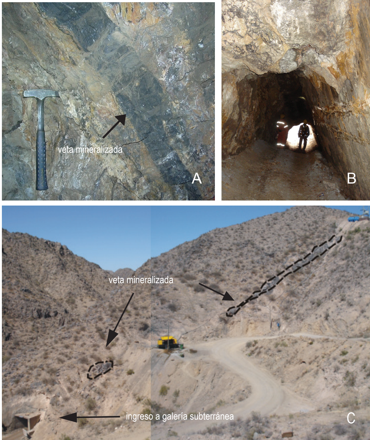
Figura 1. Yacimiento Farallón Negro (plata y oro), Catamarca, Argentina. A. Interior de mina, veta con plata y oro en ganga de manganeso, roca de caja volcánica, ancho de veta 30 cm. B. Galería subterránea. C. Vista alejada de veta mineralizada con plata y oro. En el cuadrante inferior izquierdo se observa el ingreso a la labor subterránea. Fotos: Natalia Salado Paz.
